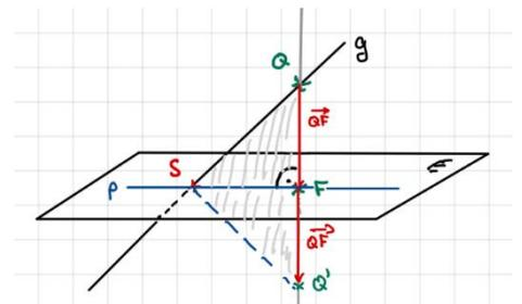
Senkrechte Projektion:  $p: \vec{X} = \vec{S} + \sigma \cdot \vec{SF} = \begin{pmatrix} -2 \\ -4 \\ -2 \end{pmatrix} + \sigma \cdot \begin{pmatrix} 2 \\ 7 \\ 3 \end{pmatrix} \text{ mit } \sigma \in \mathbb{R}$
